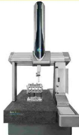
Global Scan+ di Hexagon unisce la capacità di scansione tattile alla flessibilità di una testa di misura automatica.
