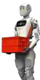
*Il robot Apollo di Apptronik fa da collegamento fra logistica e produzione, consegnando alla linea kit di montaggio da assemblare, ispezionandone contemporaneamente i componenti.*
